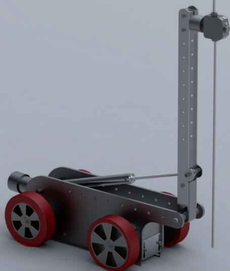
Der TWK300 Drive ist ein Tankreinigungskopf mit Antrieb für horizontal ausgerichtete Tanks. Der ausklappbare und verstellbare Arm erlaubt die Verwendung des TWK300 Drive in jedem Tank mit einem Durchmesser von ein bis drei Meter. Zusammengeklappt passt das Gerät durch ein Schacht Eingang ab einem Durchmesser von 400 mm. Der Tankreinigungskopf verfügt über einen hydraulischen Antrieb, der höhere Leistungen und eine gut einstellbare Fahrgeschwindigkeit des TWK300 Drive gewährleistet.
